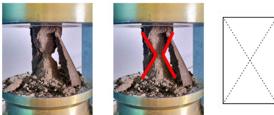
Figura 7 - Ruptura do tipo cônica
