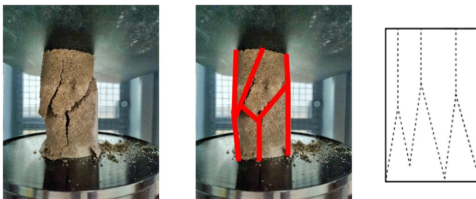
Figura 10 - Ruptura do tipo coluna com formação de cones
